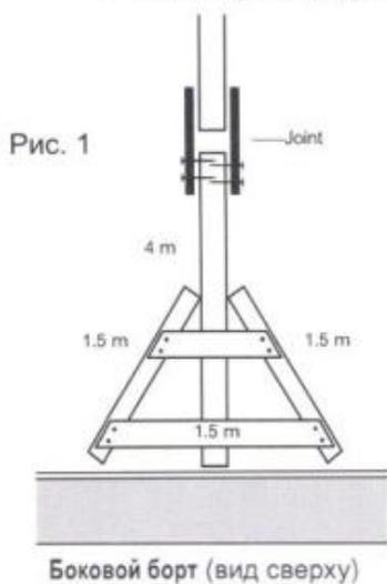
Чтобы шайба постоянно оставалась в игре, рекомендуется сооружение "углового борта". Конструкция должна иметь те же размеры, что и борта, установленные вдоль синих линий. Схема конструкций показана на Рис. 1 и 2.
